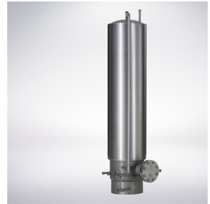
Speicherprinzipien sind auch kombiniert einsetzbar: 150-l-Warmwasserspeicher (sensibel) mit innenliegendem Wärmeübertrager (Thermobatterie L-0-T), erweitert um 2-kWh-Latentwärmespeicher auf Natriumacetat-Basis in der Behälterwand (entspricht weiteren 50 Litern Wasser).
