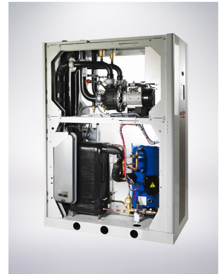
Abb. 1: Für Abwärmenutzung aus Kühlwasser geeignete Wärmepumpe (Wasser-Wasser-Wärmepumpe 61WG von Carrier, Heizleistung 29 bis 117 kW). Sichtbar sind Verdichter, Umwälzpumpe sowie Verdampfer und Verflüssiger, ausgeführt als Plattenwärmeübertrager.
