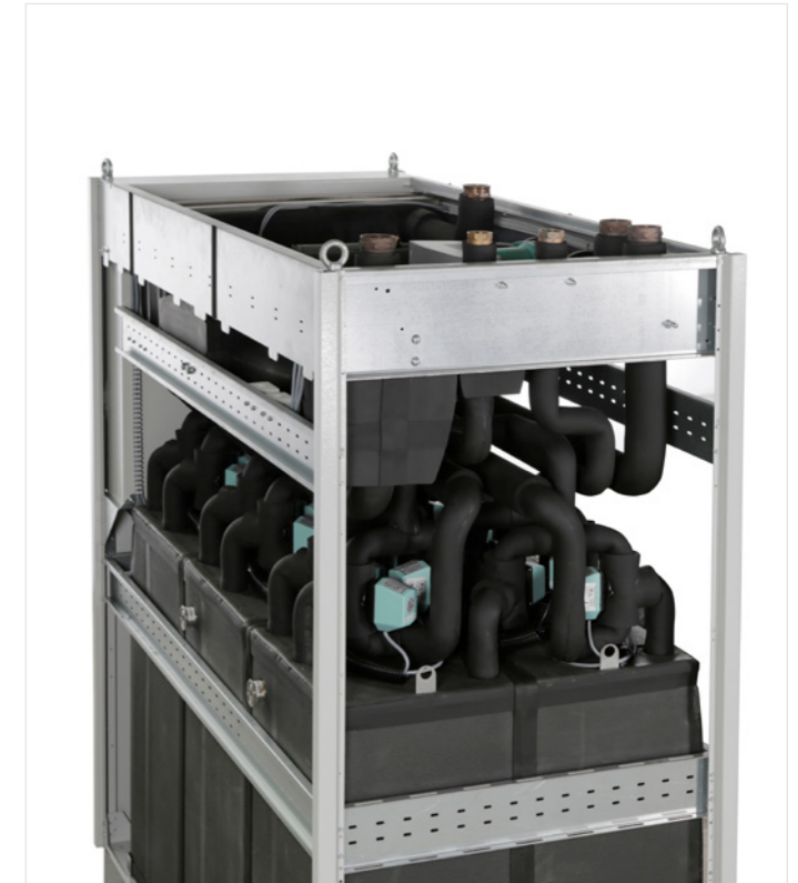
Adsorptionskältemaschine auf Silikagel-Basis [eCoo Industry von SorTech], betrieben mit Heißwasser zwischen 50 und 90 °C, bis 48 kW Kälteleistung (8 bis 21 °C, ζ = 0,65)
