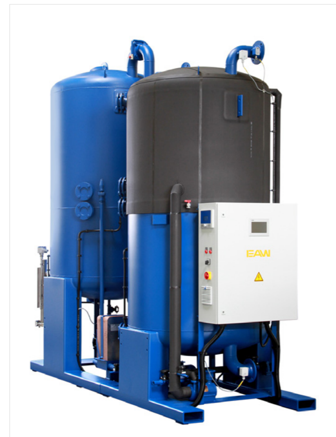
Absorptionskältemaschine (WEGRACAL SE 200) mit Stoffpaarung Wasser/LiBr und 200 kW Kälteleistung (Kühlwasser bei 9 °C). Bestehend aus Verdampfer-Absorber-Einheit (vorn) und Kondensator-Austreiber-Einheit, heißwasserbetrieben (266 kW, 86 °C, ζ=0,75).
