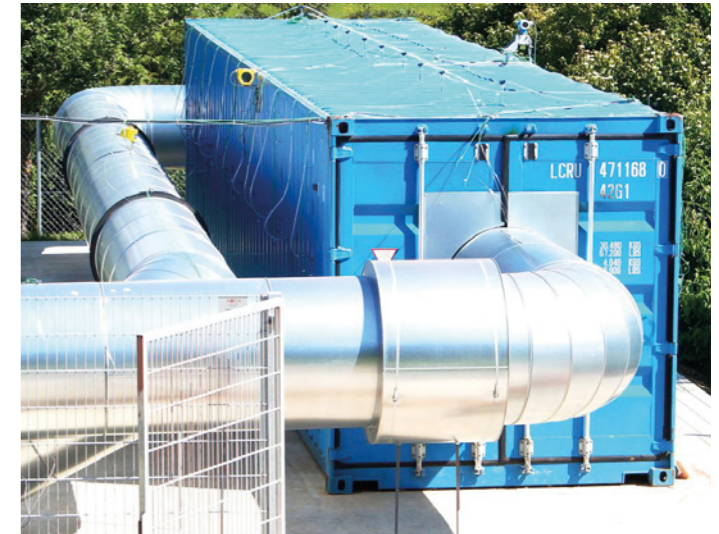
Abb. 7: Modularer Wärmespeicher mit Beton als Speichermedium
